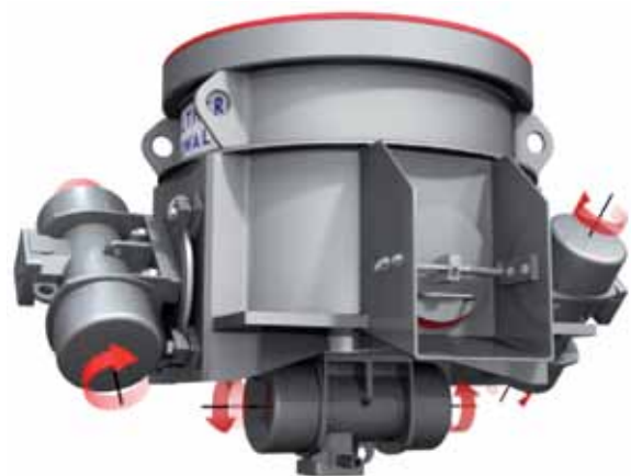
Mašina opremljena sa dva, alternativno tri vibraciona motora
