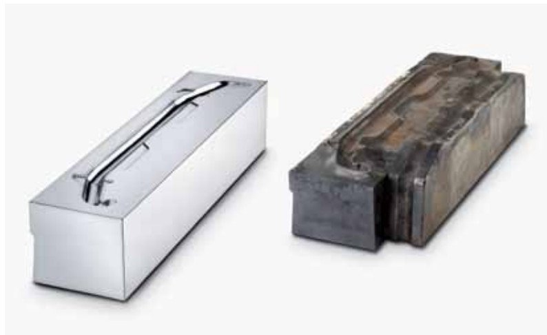
Očišćen i ponovo osposobljen kovački alat
